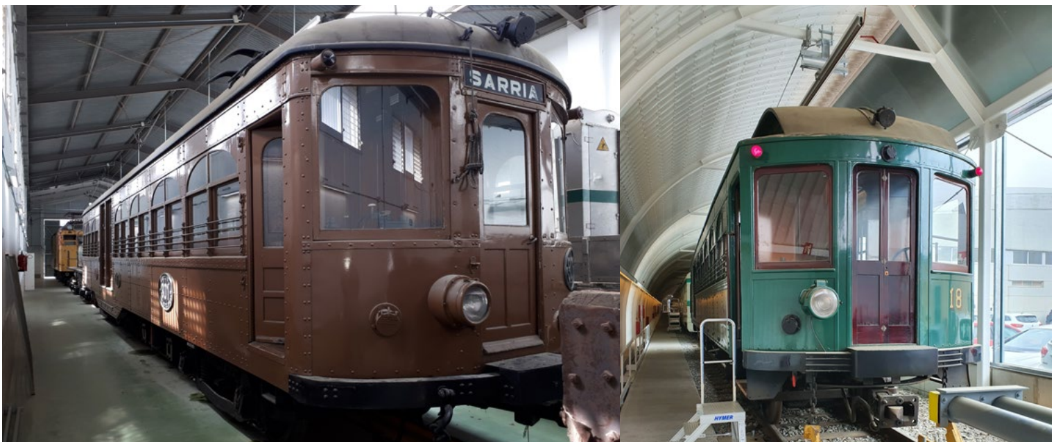
L'automotor elèctric FCC 18 de 1914, construït per The J.G. Brill Company a Filadèlfia (USA) i preservat al Centre Operatiu de Rubí. Foto Antoni Gras.
