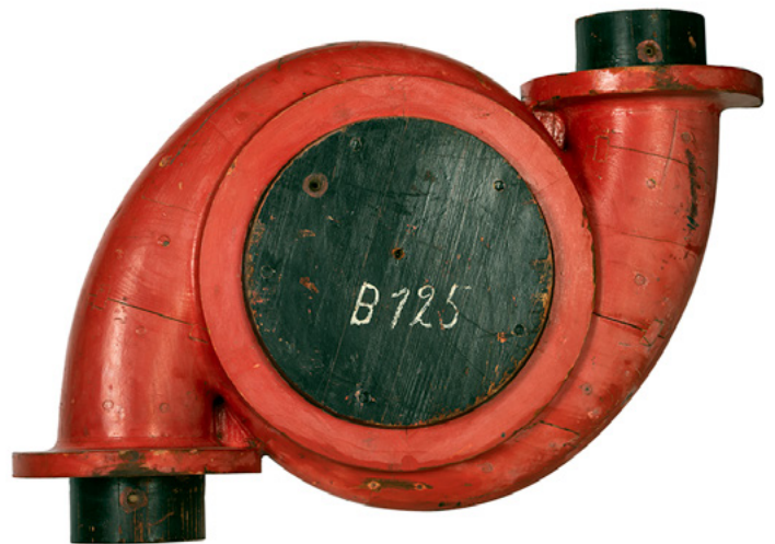
Motlle de bomba de la dècada de 1950 inventariat mitjançant el coneixement dels Amics del Museu. Imatge Museu de les Aigües. 2021
